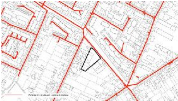
Fig. 1b: rețea de canalizare
