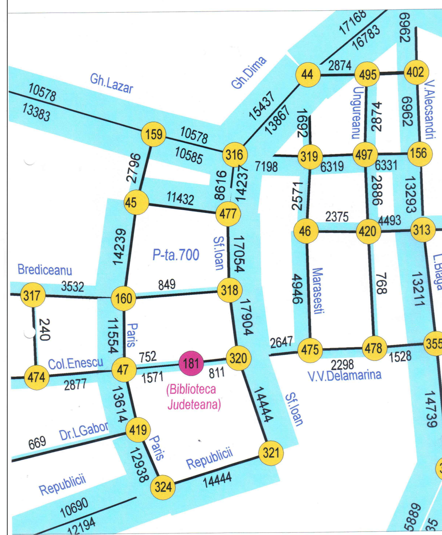
Anexa nr. 2 Plan de fluxuri de circulatie (Vv/14h) - Etapa actuala (2009) + aport Biblioteca Judetean -
