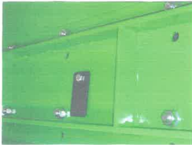
Figura 9: elemente de prindere laterale cu bolțuri de centrare
