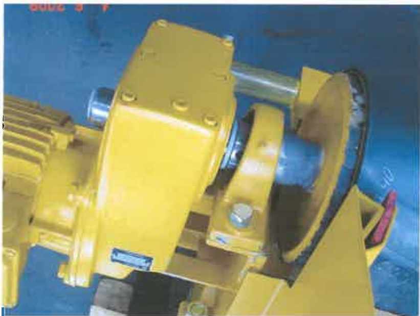
Figura 11: Tambur de antrenare bandă transversală
