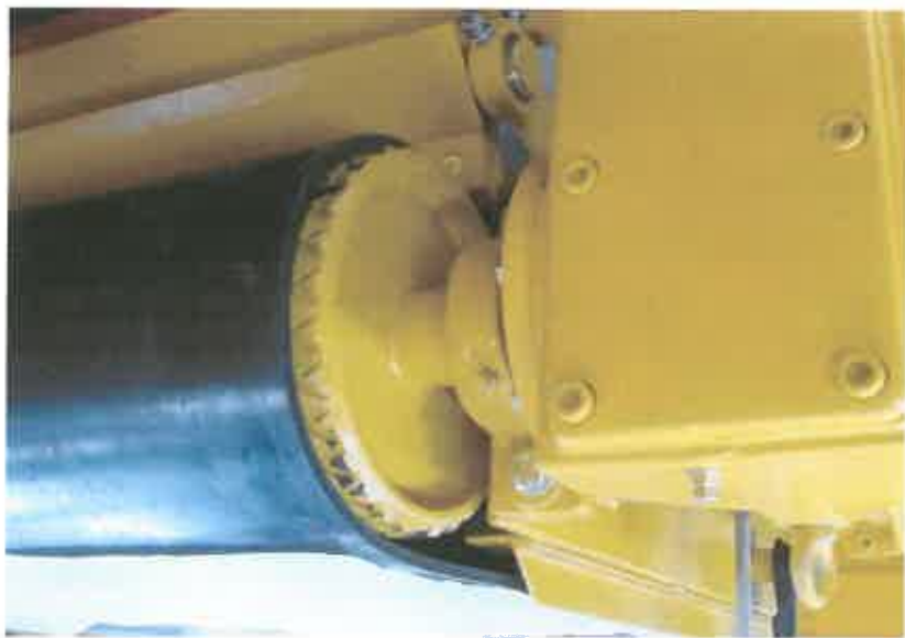
Figura 13: Tambur de antrenare bandă pentru materiale fine
