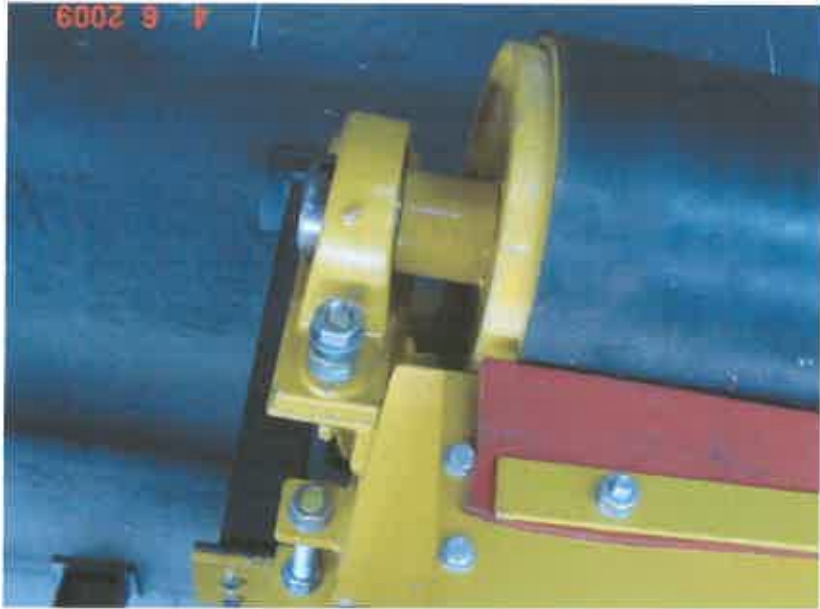
Figura 11: Tambur de antrenare bandă transversală
