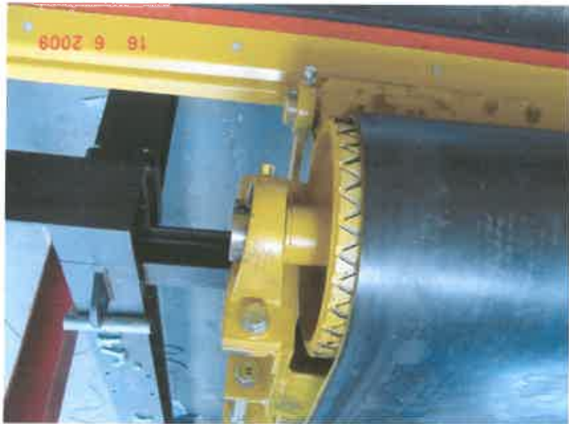
Figura 13: Tambur de antrenare bandă pentru materiale fine
