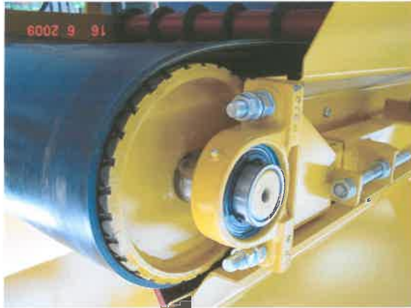
Figura 15: Tambur de antrenare bandă de alimentare (bandă de accelerare)
