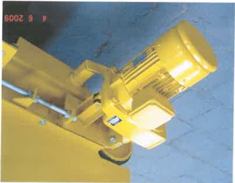
Figura 21: Motor de antrenare bandă transportoare
