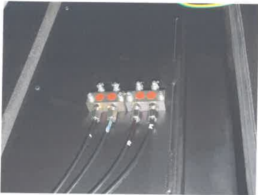
Figura 11 : ungere centrală motor electric (partea ventilatorului)
